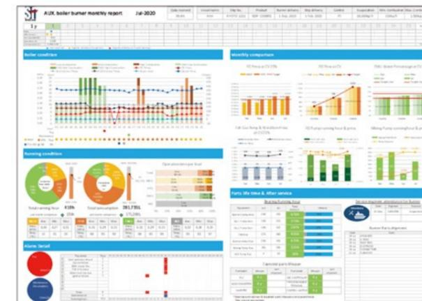
機器にはデータ収集用センサーと通信装置を装備し、本船の船陸間通信でデータを送信します。分析に必要なデータ(メーカーズファイル)は船内データロガーを経由することなく送信できるので、本船の既存設備の工事を最小に導入することができます。船から送信されたデータは当社のセキュアなサーバーで保管、分析処理を行い、運転状況を表した2種類のレポート(デイリーレポート/マン
