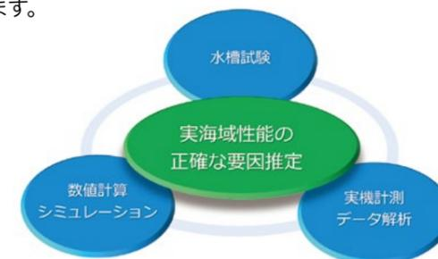
三井造船昭島研究所は、造船所を起源としつつも、現在の「造船所と独立した企業」として、実船計測データの解析技術のみでなく、高精度な水槽試験技術や大規模数値解析技術をベースに、実績に裏打ちされた性能改善技術により、データの有効利用に向けたさまざまなご提案が可能です。
